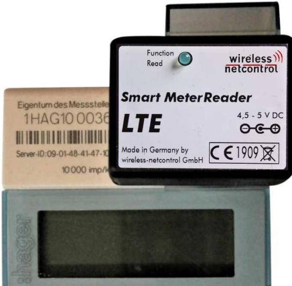
Das Smart Meter Reader LTE ist, mit dem integrierten Magneten, auf der optischen Schnittstelle wie ein herkömmlicher optischer Tastkopf zu befestigen. Nach Anschluss der externen Antenne und der Spannungsversorgung, ist das Gerät einsatzbereit. Es ist keine weitere Parametrierung notwendig, da die benötigten Informationen bereits bei der Herstellung in das Smart MeterGateway eingespielt werden.
