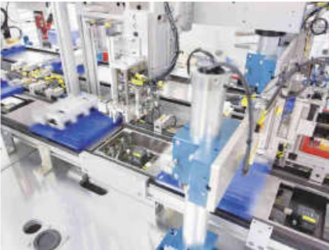
Kosteneffiziente RFID-Technologie sorgt wirtschaftlich für die nötige Flexibilität und Prozesssicherheit bei der weitgehend automatisierten Montage und Prüfung von rund 80 Varianten von Kanalsteckdosen
