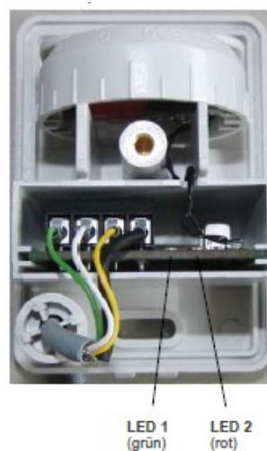
Funktions-Modul, eingebaut und angeschlossen
